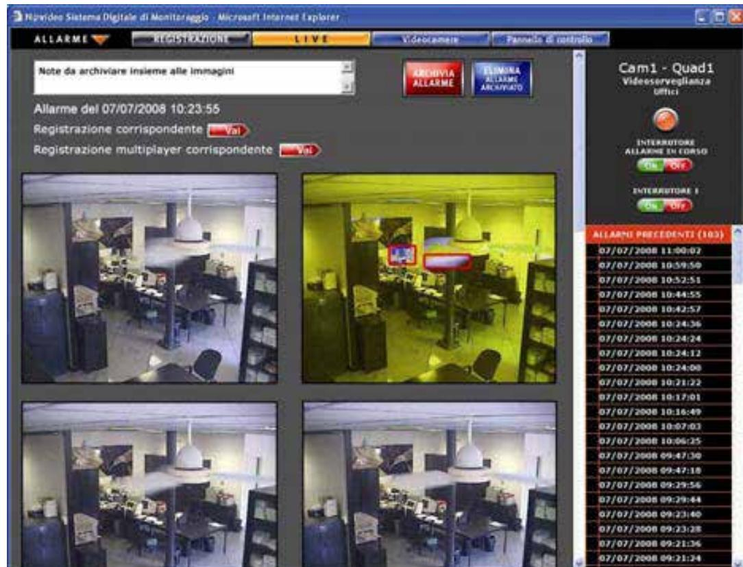
I punti video possono essere programmati per reagire a fronte di un evento. L'evento può essere generato dalla connessione con sistemi di allarme esterni, da input o motion detection rilevato direttamente dalla camera o dal server (attivazione solo in presenza di movimento/staticità delle immagini).
